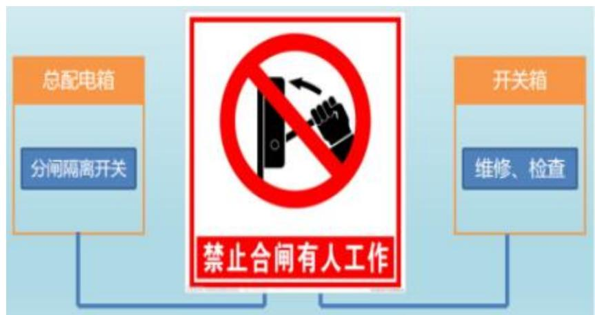
图 C-3 停电标志牌示例图
