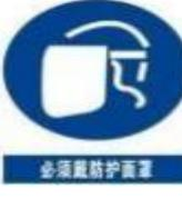
必须戴防护面罩  | 必须戴防护面罩 | 尺寸为 300X400,<br>粘贴或悬挂。 | 易造成人体紫外线辐射的作业场所。如电焊作业场所。              |
